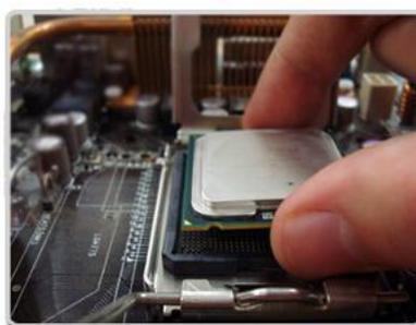
**Figura 19.** Encaixe do processador.
